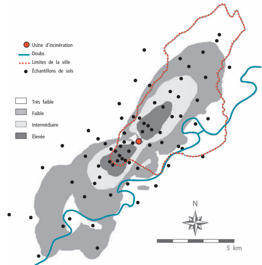
Figure 1. Modélisation des retombées atmosphériques de dioxines et localisation des prélèvements de sol, autour de l'usine d'incinération d'ordures ménagères de Besançon, France / Figure 1. Modelled ground-level dioxin concentrations and soil sample locations around the municipal solid waste incinerator of Besançon, France
