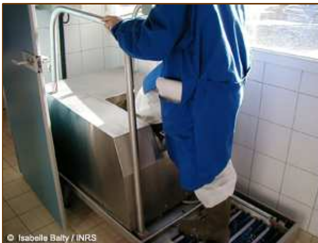
© Isabelle Balty / INRS Lavage des bottes à la sortie du poste de travail avant de passer au vestiaire
